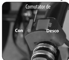
Comutatorul motorului este pe mânerul panoului operatorului.
